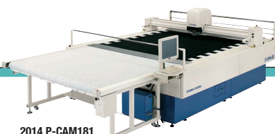
2014 P-CAM181 積層式 自動裁断機
