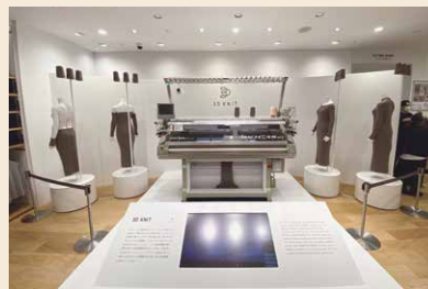
ユニクロ銀座店に設置されたホールガーメント横編機
