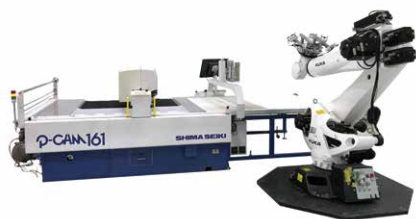
上記展示会で紹介した P-CAM®とロボットアームとの 連動による自動ピックアップ
