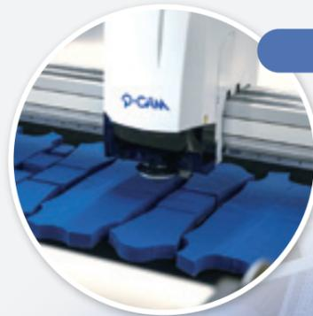
**刃幅自動測定装置 (P-CAM®)**
